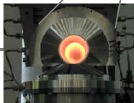
Blick durch die Eintrittsöffnung für die Solarstrahlung in den Reaktor nach einem Experiment
